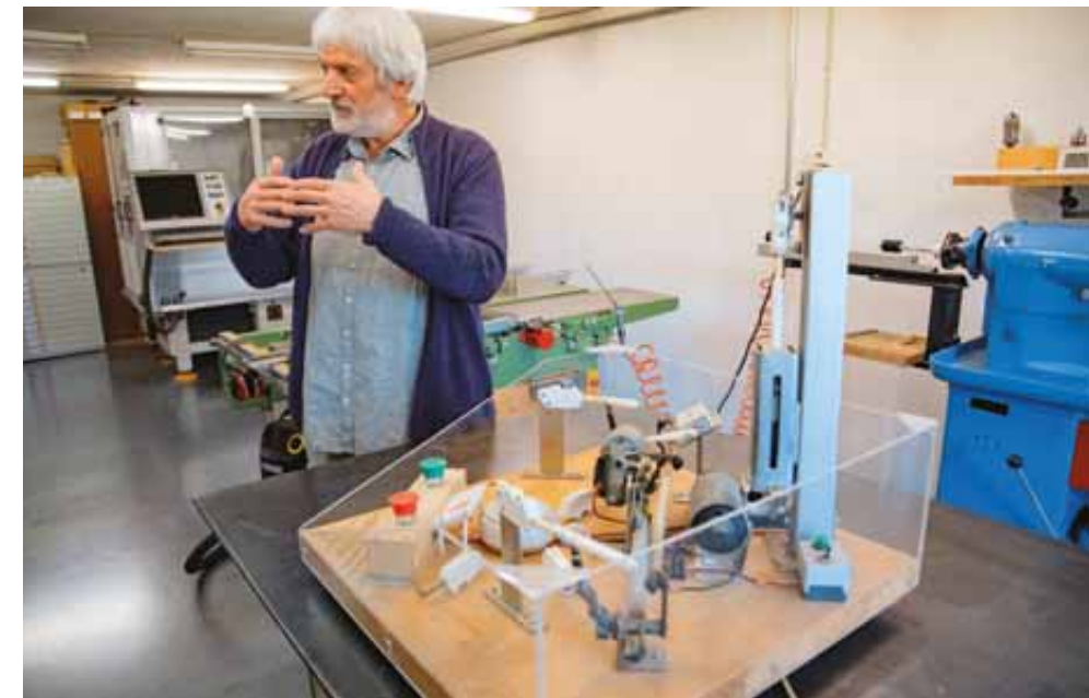
Stephan Berger davanti all'unità di prova che ha creato, con la quale ha svolto dei test di resistenza e affaticamento del materiale della cerniera in plastica con sistema clic da lui progettata.
